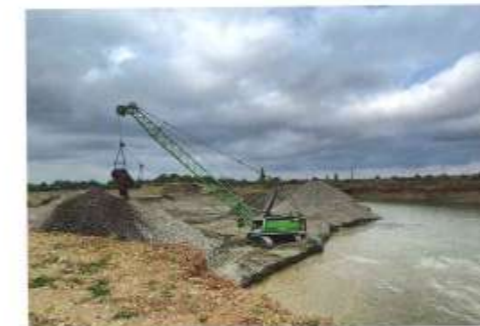
La dragline permet de récupérer les fines et donc d'exploiter de manière optimale les sites.
